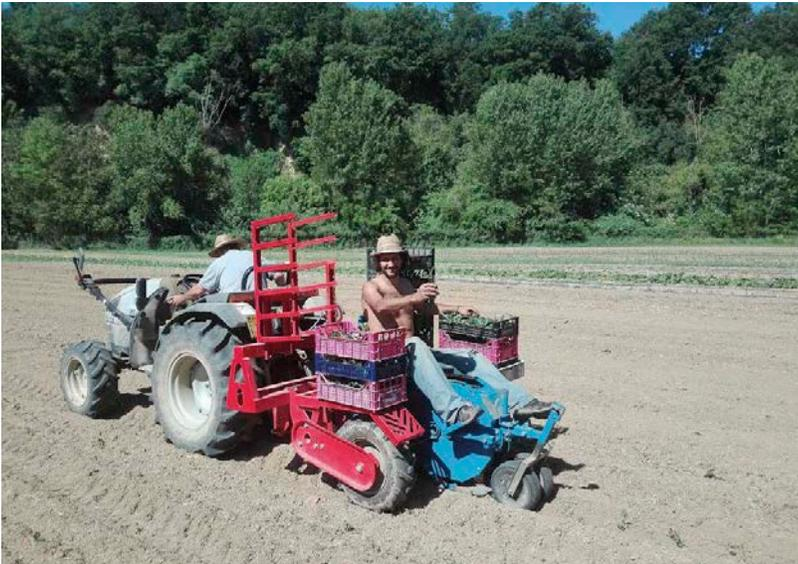
**Trapiantatrice professionale, molto utile per ridurre drasticamente i tempi di messa a dimora delle piantine di ortaggi.**
